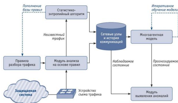
Рисунок 3 - Схема выявления аномалий по CyberThymus [8].
