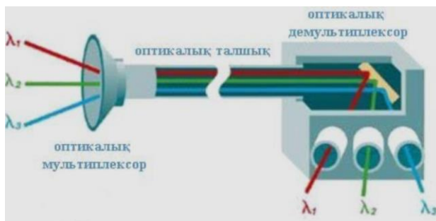
Сурет 1 - Талшықты-оптикалық байланыс жүйесінің жалпы құрылымы
